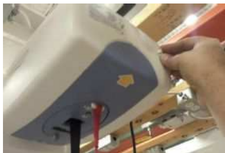
リフトの側面から、キャップを取り外す。
