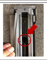
写真の固定ボルトを外します。
