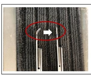
レール先端の曲がりを伸ばした 後に元の位置に戻します。
