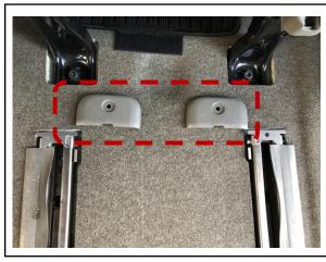
2列目スライドレール先端の樹脂製トリムを取り外します。 (左右2カ所)
