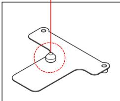
付属のガソリン車取付用の床面ベースに付いている 白色樹脂パーツをHV用床面ベースに移植します。 (樹脂パーツは側面のイモネジにて脱着できます)
