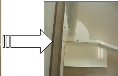
⑦ 下部写真の順で仮固定し、全ての仮固定が完了した後、増締めします。
