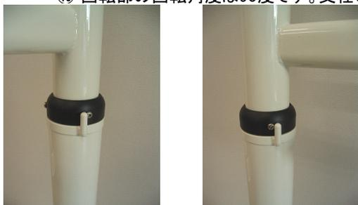
⑪ アーム回転角度を調節します。アームはアウトリガーと平行以上に回転しないように調整して下さい。参考写真のように固定ビスを設定します。
