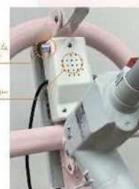
吊り具の掛け忘れ確認装置
