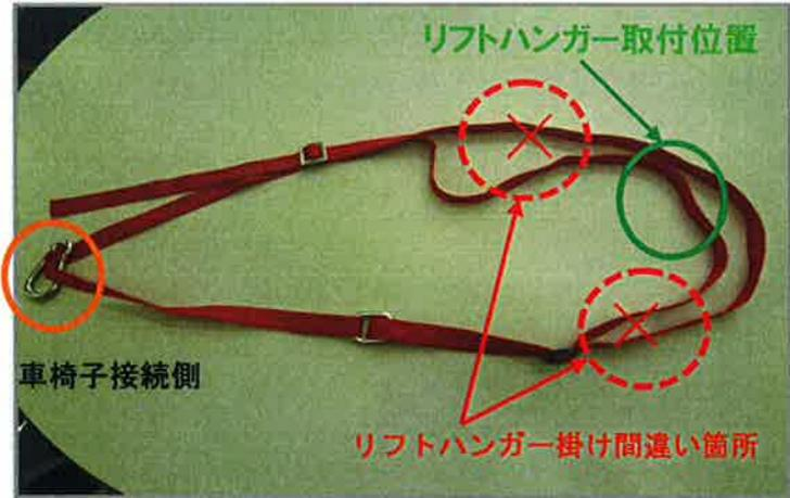
\* 上記のようにリフトハンガー取付位置のベルトが2重になっている場合は、2本のベルトの間(外側ベルトのみ)にハンガーを掛けないように注意して下さい。適正な位置は2重のベルト内側をハンガーに掛ける状態です。
