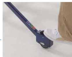
後輪キャスター (REH) 3段切替式 ①フリー(前進・後進) ②逆転防止(前進のみ) ③前進負荷付(前進のみ)
