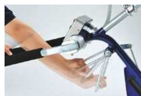
前輪用手元切替レバー 上段:ブレーキ 中段:自由走行 下段:直進走行
